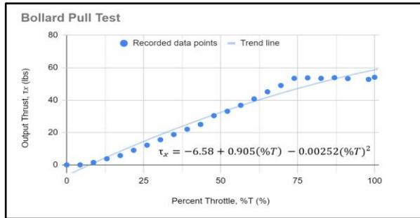
Fig 11. Bollard Pull Test Data.
