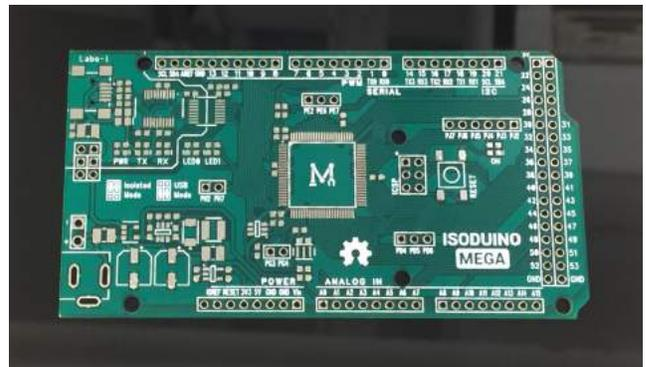
Fig. 8: A Printed Isoduino
